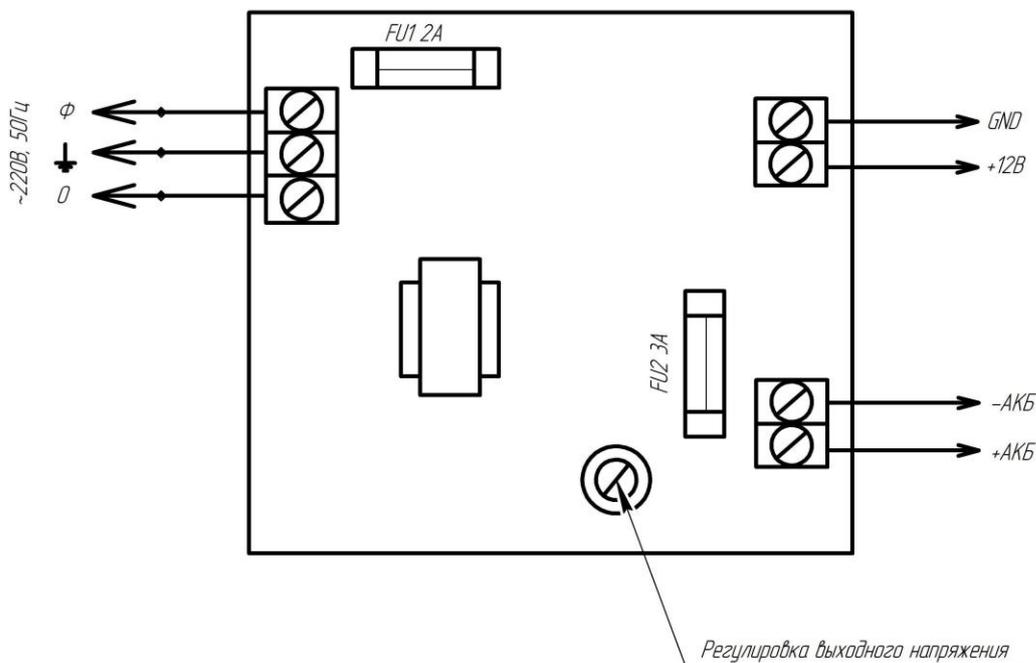
При длительном отключении БП (более суток) и при снятом напряжении 220В, целесообразно отключить аккумулятор, сняв клемму «+».
